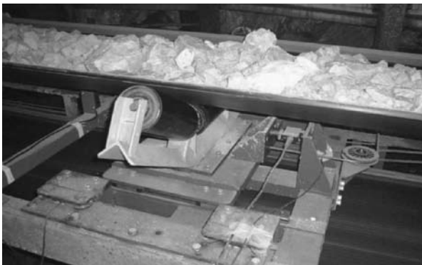
▲ รูปที่ 2 ระบบสายพานลำเลียงแบบเอ็ง เมื่อติดตั้งสายพานลำเลียงประหยัดพลังงาน (eco carry)
